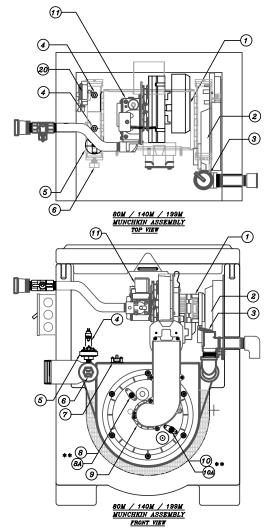
\*\* THE LOCATION OF THE HOT SURFACE IGNITOR AND FLAME RECTIFICATION PROBE IS REVERSED FOR ALL HA MODELS
